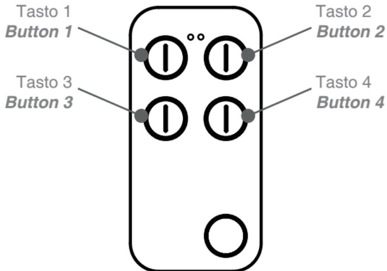
Radiocomando rolling code 433,92MHz, 4 tasti con funzione impostabile.
